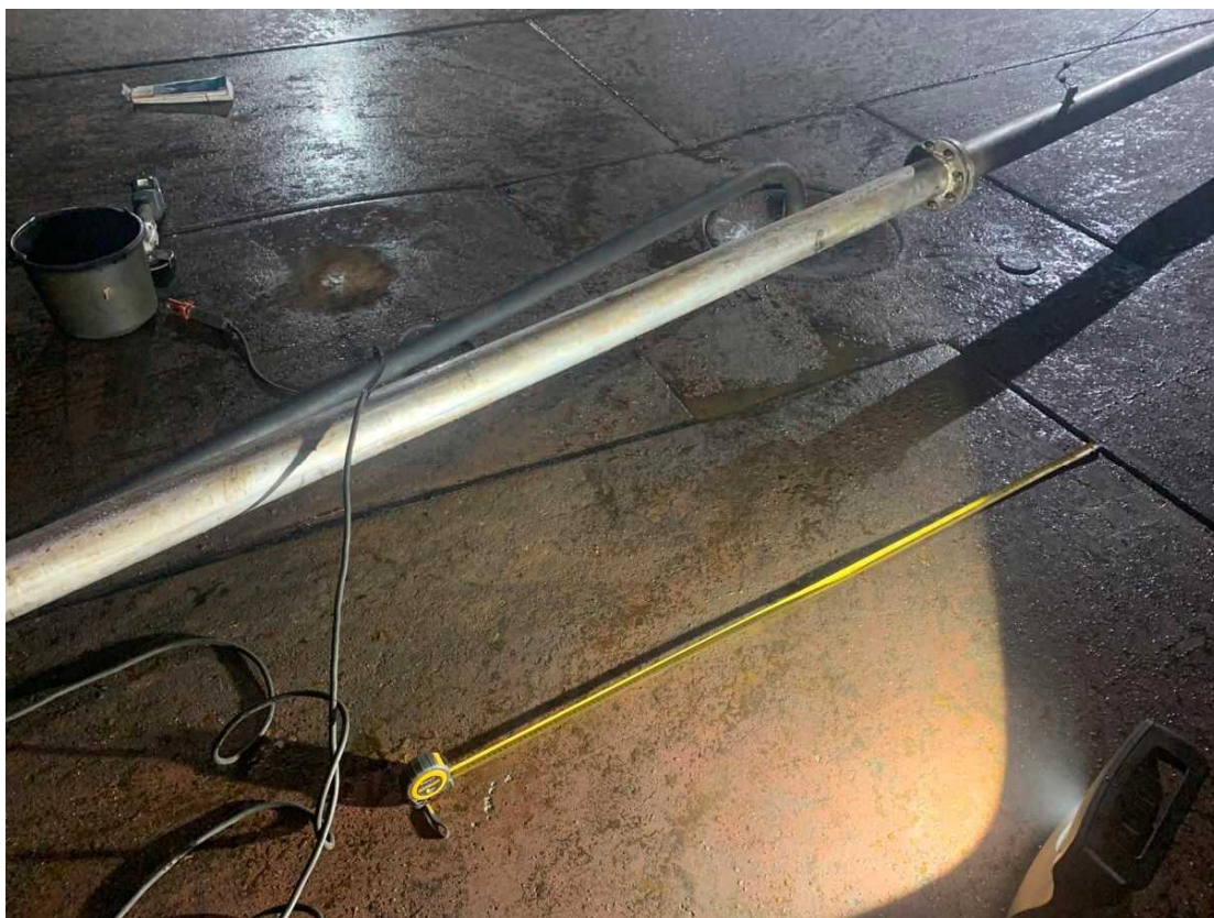
Mynd 3. Pyttaklasi fannst í plötu 21 sem var 2,4mm a dýpt í 7,6 mm þykkri plötu.
