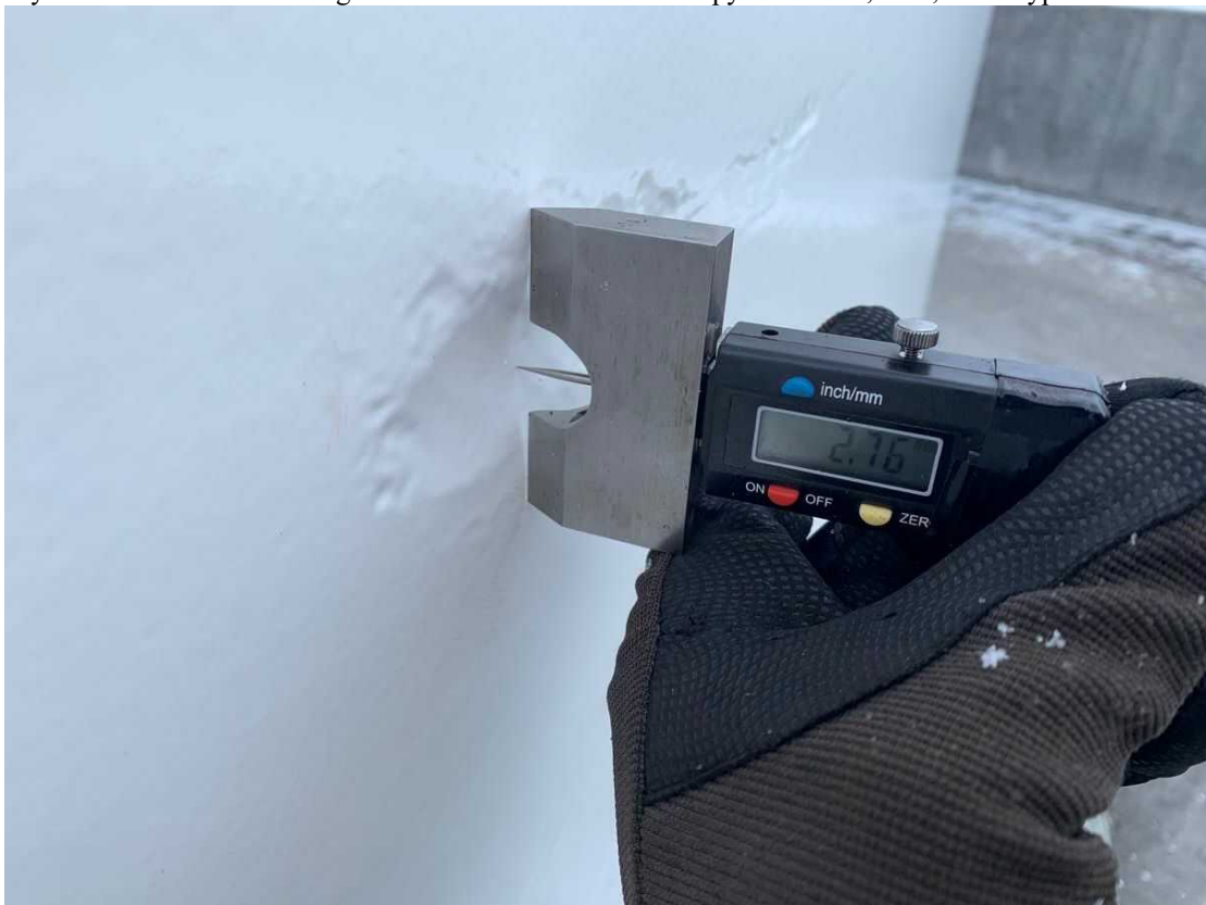
Mynd 9. Geymir virðist nýmálaður. Hér er ummerki pytts sem hefur náð 2,76 mm dýpt.
